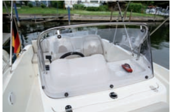
Sehr stabile Windschutzscheibe, eingrahmt vom VA-Handlauf.
