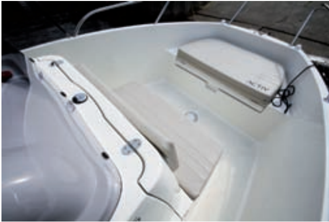
Blitzschneller Umbau: Das Zwischenteil der Sonnenliege wird samt Polster in den Bugbereich geklappt.
